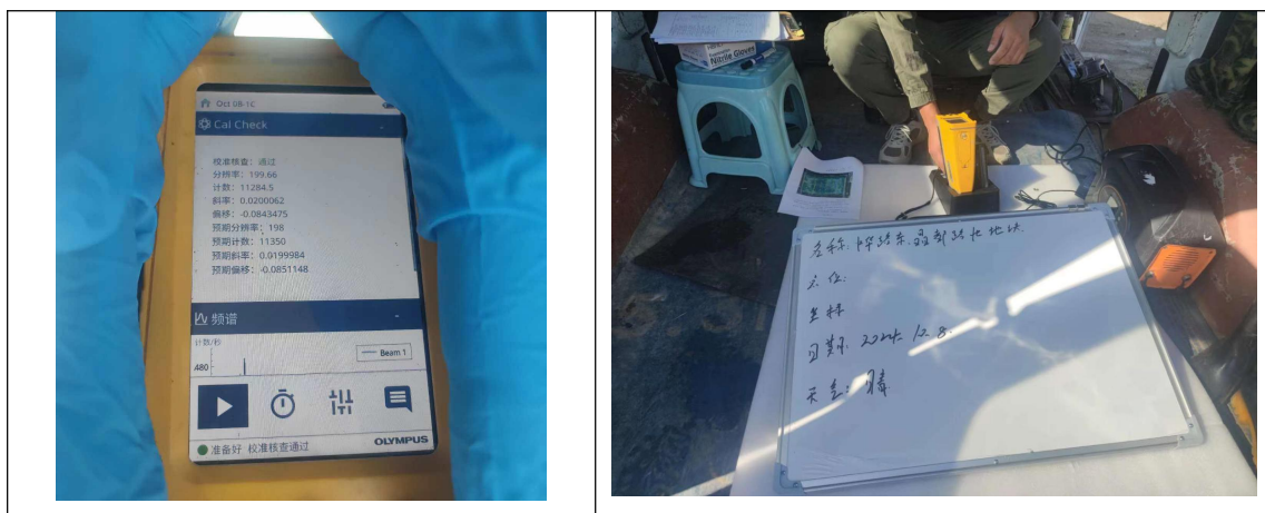
图 3.3-2 XRF 校准及检测
