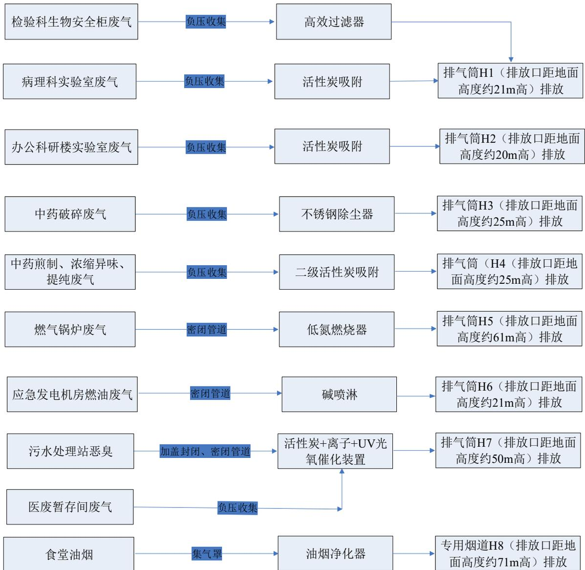
图2.3.8-1 项目变动前有组织废气污染物走向情况
