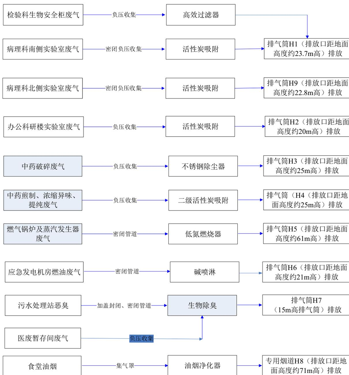
图2.3.8-2 项目变动后有组织废气污染物走向情况
